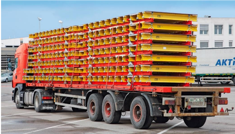
Fig. 2. Transporte de encofrado [Fuente: PERI]
