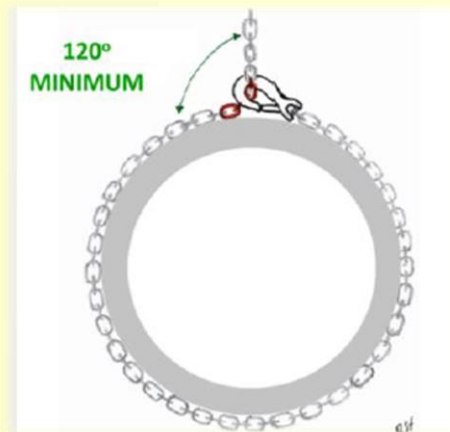
Fig.3 Amplitud mínima del ángulo de la eslinga cuando la carga está amarrada [porozumieniedlabezpieczenia.pl]
