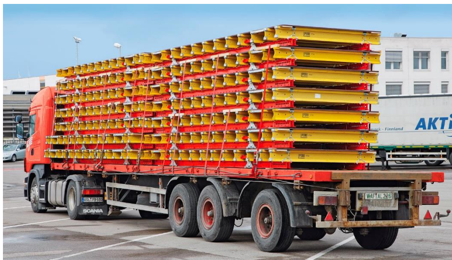
Rys. Transport deskowania [Źródło: PERI]
