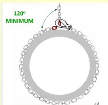
Minimalny kąt zagięcia cięgna przy obwiązywaniu elementu [16]
