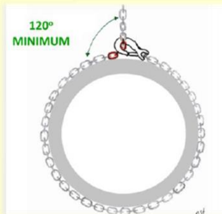
Der minimalen Strängen-Winkel beim Umseilen eines Teils [16].
